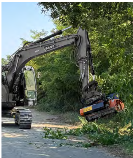
Für Bagger mit 1,5 bis 20 t Einsatzgewicht bietet Müthing Mulchköpfe mit Arbeitsbreiten von 60 bis 160 cm.
