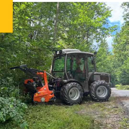
Müthing bietet Mulchgeräte mit Arbeitsbreiten von 1,60 bis 2,20 m – ideal für Trägerfahrzeuge im Leistungsbereich von 60 bis 250 PS.
