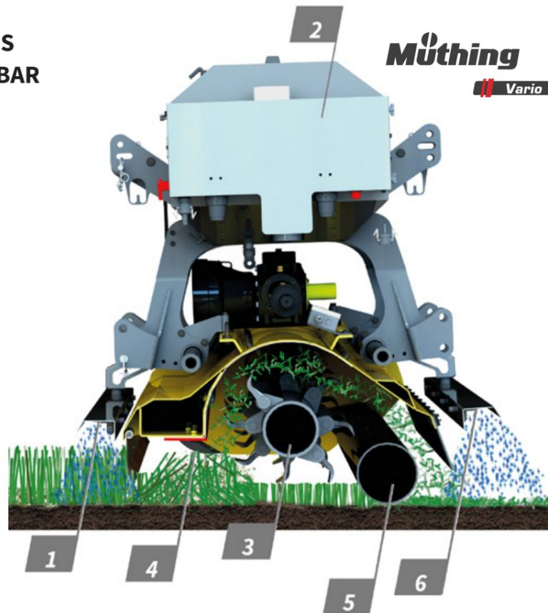
**Hauptkomponenten** sind ein Spritzbalken (1) vorne, der Tank mit Pumpe (2), der Doppelspiralrotor (3) mit Gegenschneide (4), die Stützwalze (5) und ein Spritzbalken (6).hinten.
