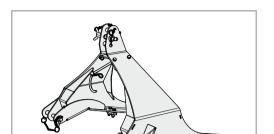
Für den Anbau von speziellen Trägerfahrzeugen steht ein feststehender Anbaubock zur Verfügung.
