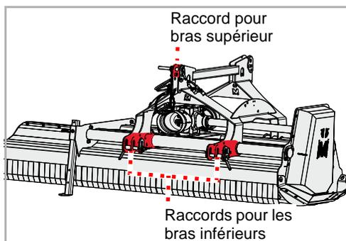
L'attelage peut être utilisé sur les tracteurs avec des raccordements de bras inférieurs de catégorie II.
