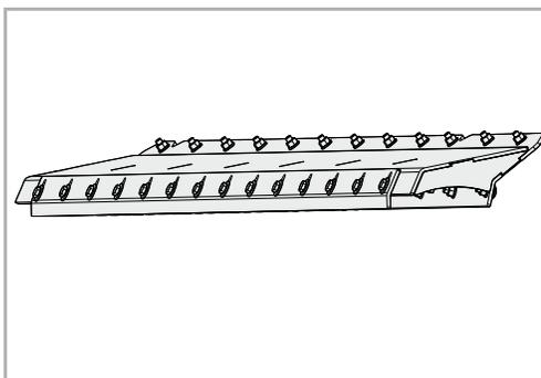
Pour le dépôt du produit de coupe devant le rouleau d'appui vous avez besoin d'une rallonge d'éjection qui doit être échangée contre le pare-pierre monté en usine. Le dépôt du produit de coupe devant le rouleau d'appui peut s'avérer avantageux lorsque la machine est utilisée sur des champs.
