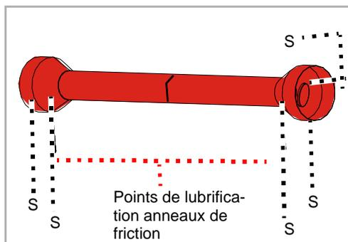
En cas de charge importante ou de conditions de travail extrêmes, notamment en cas de niveaux de poussière élevés, une lubrification plus fréquente est nécessaire.
