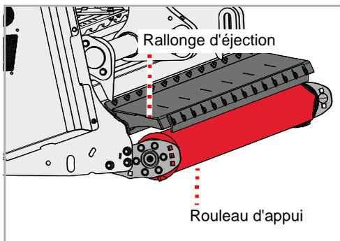
Le dépôt du produit de coupe devant le rouleau d'appui n'est possible qu'avec une rallonge d'éjection [+]. Le rouleau d'appui roule sur le produit de coupe.
