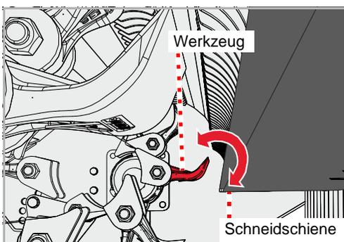
Prüfen Sie, ob die Schneidschiene von den Werkzeugen berührt wird.
