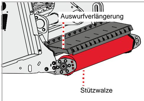
Die Ablage des Schnittguts vor der Stützwalze ist nur mit einer Auswurfverlängerung [+] möglich. Die Stützwalze läuft auf dem Schnittgut.
