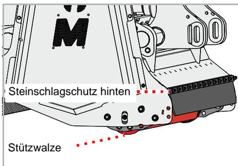
Die Ablage des Schnittguts hinter der Stützwalze ist die häufigste Einstellung. Die Stützwalze läuft direkt auf dem Boden.
