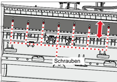
Nach dem Einstellen der Schneidschiene müssen Sie prüfen, ob Werkzeuge die Schneidschiene berühren.
