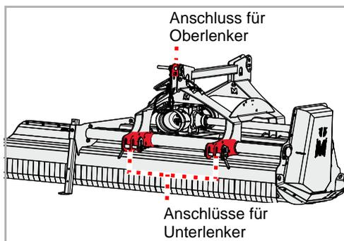
Der Anbau kann an Traktoren mit Anschlüssen für Unterlenker mit Kategorie II vorgenommen werden.
