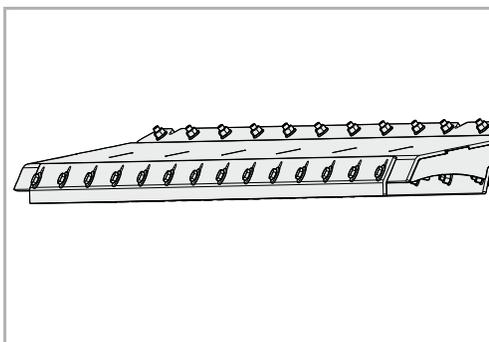
Für die Ablage des Schnittguts vor der Stützwalze benötigen Sie eine Auswurfverlängerung, die gegen den werkseitig verbauten Steinschlagenschutz ausgetauscht wird. Die Ablage des Schnittguts vor der Stützwalze kann bei einem Einsatz der Maschine auf Ackerflächen von Vorteil sein.
