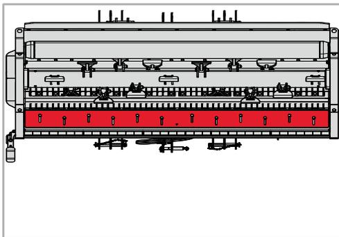
Mit Hilfe einer Schneidschiene kann der Grad der Zerkleinerung verändert werden. Sie können so bestimmen, wie fein das Material zerkleinert werden soll.
