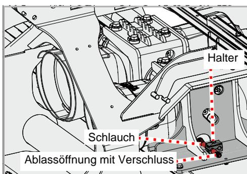
Das Getriebe ist mit einem Schlauch für das Ablassen des Öls ausgestattet.
