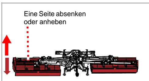
Sie können mit der Einzelsteuerung die Seitenteile der Maschine getrennt anheben oder absenken.
