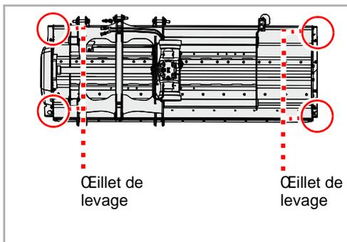
Pour le transport, par exemple sur une remorque, il est possible de lever la machine. Utilisez uniquement les points indiqués pour la mise en place des équipements de levage. La machine doit être arrêtée de manière appropriée.
