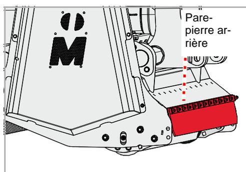
Pour pouvoir effectuer la modification, il faut disposer d'une rallonge d'éjection [+] pour le montage d'un rouleau d'appui en dehors du carter.
