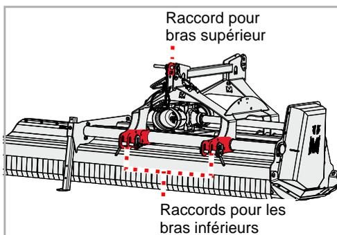
L'attelage peut être utilisé sur les tracteurs avec des raccords de bras inférieurs de catégorie II.
