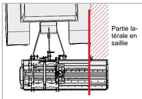
La machine peut être montée à l'arrière ou devant le tracteur, ou encore décalée sur le côté.
