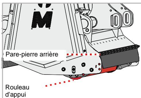
Le dépôt du produit de coupe derrière le rouleau d'appui est le réglage le plus fréquent. Le rouleau d'appui roule directement sur le sol.
