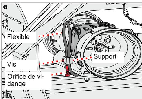
La transmission est équipée d'un tuyau pour la vidange de l'huile.
