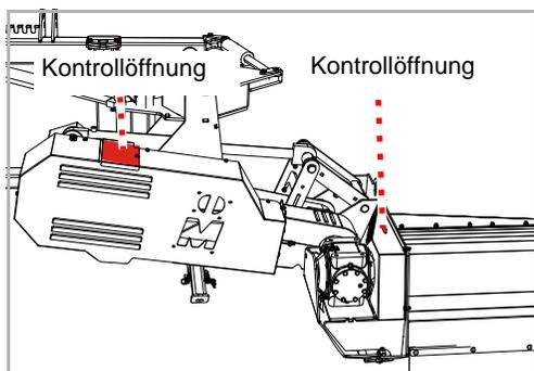
An der Maschine sind zwei Kontrollöffnungen angebracht.
