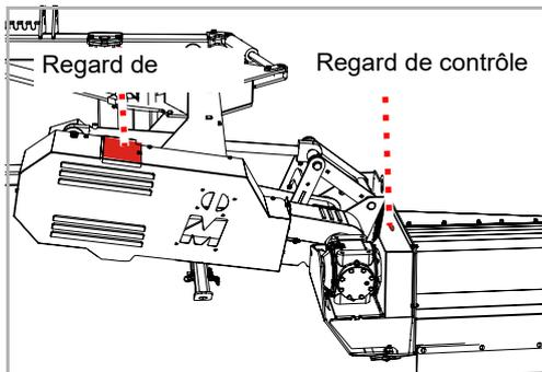
La courroie trapézoïdale est tendue au moyen d'un ressort. En cas de tension insuffisante de la courroie trapézoïdale, celle-ci doit être retendue. Si la courroie trapézoïdale présente des entailles ou est endommagée, il faut la remplacer.
