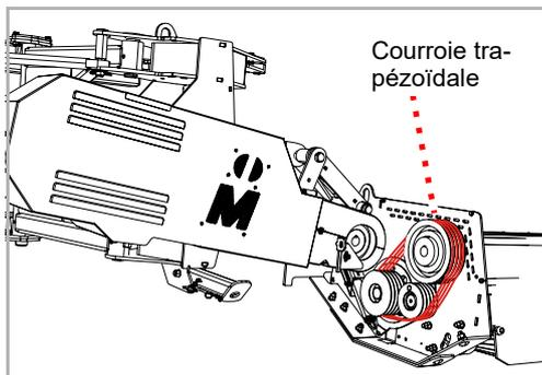
La courroie trapézoïdale 2 se compose de plusieurs courroies trapézoïdales étroites.
