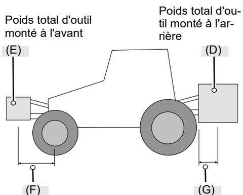
Distance : Centre de gravité d'outil attelé à l'avant jusqu'au milieu d'essieu avant
