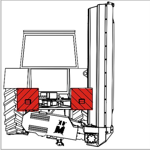
Pour le transport de la machine sur route, des panneaux de signalisation avec dispositifs d'éclairage intégrés sont disponibles.
