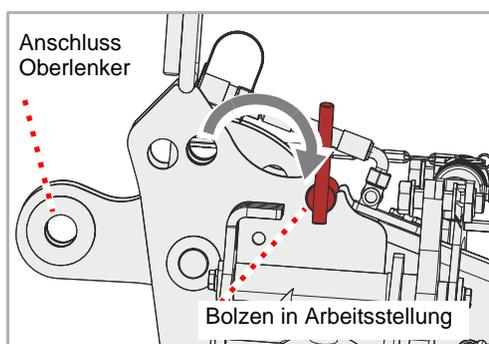
Der Bolzen sichert die Maschine für den Straßentransport. Für das Mulchen müssen Sie den Bolzen in Arbeitsstellung umstecken.
