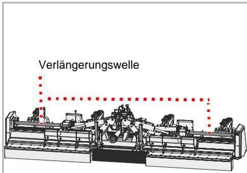
Die Verlängerungswelle links und die Verlängerungswelle rechts auf der Maschine sind in Öl gelagert. Das Getriebeöl muss den Spezifikation entsprechen.
