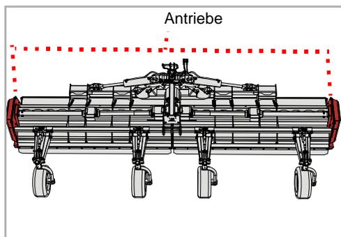
An der Maschine sind zwei Antriebe mit Antriebsriemen angebracht.
