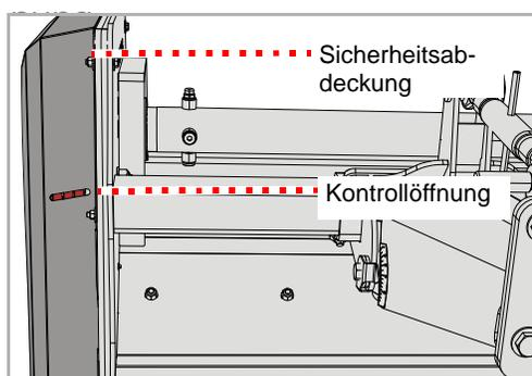
In der Sicherheitsabdeckung befindet sich eine Kontrollöffnung.
