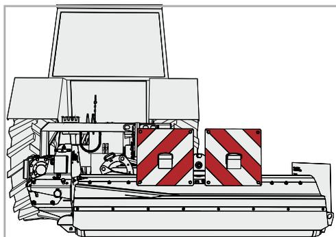
公道で作業機をさまざまな位置で輸送するために、照明装置付きの調整式警告標識が用意されています。
