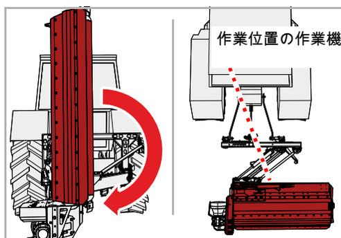
▶ トラクターのコントロールユニットにより作業機を作業位置に繰り出します。
