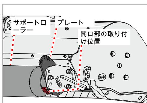
プレートにサポートローラーを取り付ける際、開口部が後で作業機から離れることに注意してください。ベアリングが過度に摩耗したり、汚れが付着しないよう注意してください。
