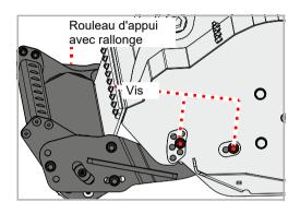
Si vous avez monté un rouleau d'appui avec rallonge, vous devez le démonter. Les pièces d'assemblage du rouleau d'appui standard sont nécessaires pour la modification.
