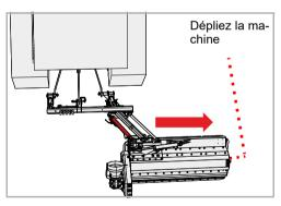
Pivotez la machine dans la position souhaitée au moyen du distributeur du tracteur
