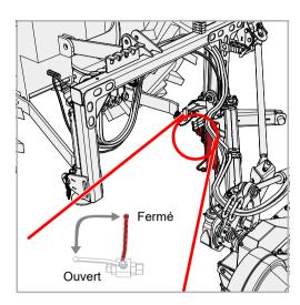
Placez le robinet d'arrêt du vérin hydraulique 1 en position « Fermé »
