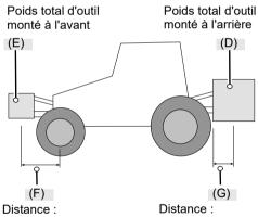
Distance : Centre de gravité d'outil attelé à l'avant jusqu'au milieu de l'essieu avant Distance :
