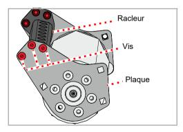
▶ Positionnez les racleurs et fixez-les sur les deux côtés de la machine au moyen des vis, rondelles et écrous autobloquants, sans serrer à bloc
