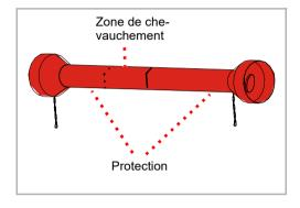
Contrôlez l'encrassement de l'arbre de transmission et, le cas échéant, nettoyez-le. De la poussière combinée à de l'huile et de la graisse peut aboutir à une usure élevée
