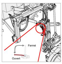
Placez le robinet d'arrêt du vérin hydraulique 1 en position « Ouvert »
