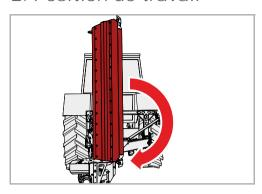
Déployez la machine en position de travail au moyen du distributeur du tracteur
