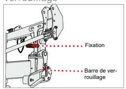
La barre de verrouillage doit être retirée pour le broyage.
