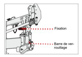
Vérifiez que la machine est bien sécurisée à l'aide de la barre de verrouillage
