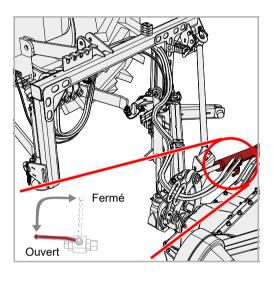
Placez le robinet d'arrêt du vérin hydraulique 2 en position « Ouvert »
