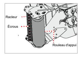
Le racleur doit être réglé à faible distance du rouleau d'appui. Vous devez régler le racleur s'il est usé ou si vous l'avez monté sur le rouleau d'appui de rallonge.
