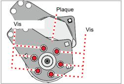
Fixez la plaque de chaque côté du rouleau d'appui au moyen des vis
