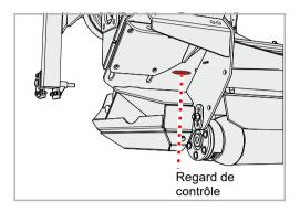
La courroie trapézoïdale est tendue au-dessus d'une plaque de serrage. En cas de tension insuffisante de la courroie trapézoïdale, celleci doit être retendue. Si la courroie trapézoïdale présente des entailles ou est endommagée, il faut la remplacer.
