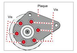
Le rouleau d'appui et les pièces d'assemblage du rouleau d'appui standard sont nécessaires pour la modification.
