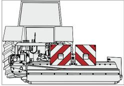
Des panneaux de signalisation réglables avec système d'éclairage sont disponibles pour le transport de la machine sur route dans différentes positions.
