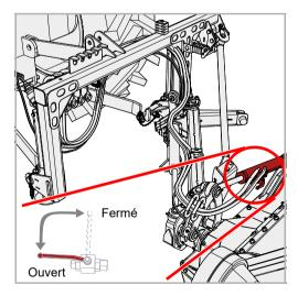
Placez le robinet d'arrêt du vérin hydraulique 2 en position « Ouvert »
