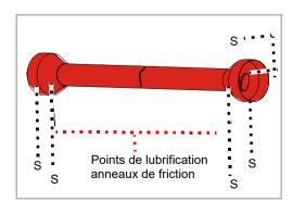
En cas de charge importante ou de conditions de travail extrêmes, notamment en cas de niveaux de poussière élevés, une lubrification plus fréquente est nécessaire.
