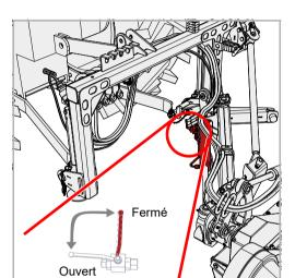
Placez le robinet d'arrêt du vérin hydraulique 1 en position « Fermé »
