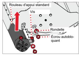
Montez le rouleau d'appui standard et fixez-le des deux côtés de la machine au moyen des vis, rondelles et écrous autobloquants. Utilisez pour cela uniquement les perçages indiqués.
