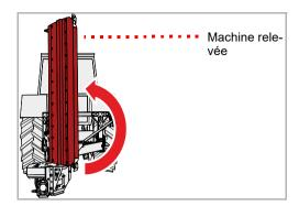
▶ Relevez la machine au moyen du distributeur du tracteur
