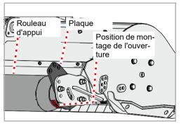
Pour monter le rouleau d'appui avec rallonge, il vous faut le rouleau d'appui démonté et les pièces d'assemblage du rouleau d'appui avec rallonge.
