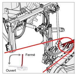
Placez le robinet d'arrêt du vérin hydraulique 2 en position « Fermé »
