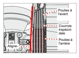
▶ Vérifier l'alignement des poulies de courroie. Les poulies situées à l'arrière doivent être alignées avec les poulies avant.
