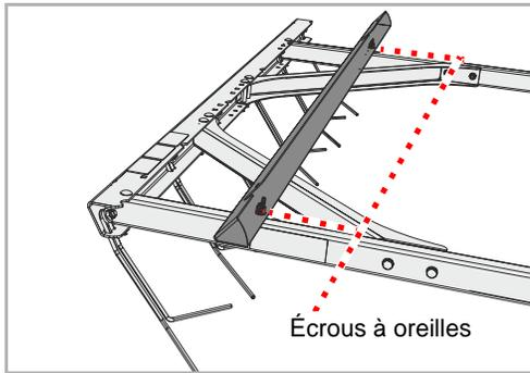
Pour le transport sur route, vous devez impérativement rabattre le sauveteur d'insectes en position de transport et le bloquer avec un rail de protection.
