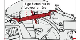
Variante tractée : si nécessaire, procéder également au réglage sur le broyeur arrière.
