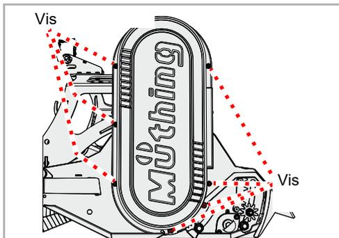
La courroie trapézoïdale est tendue au moyen d'un chariot. En cas de tension insuffisante de la courroie trapézoïdale, celle-ci doit être retenue. Si la courroie trapézoïdale présente des entailles ou est endommagée, il faut la remplacer.
