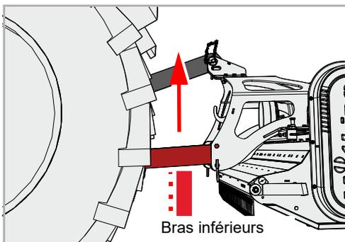
Réglez la hauteur des bras inférieurs via le relevage trois points du tracteur, de telle sorte que la machine soit suffisamment haute pour le transport
