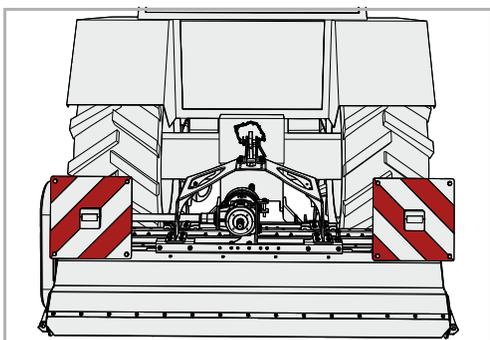
Pour le transport de la machine sur route, des panneaux de signalisation avec dispositifs d'éclairage intégrés sont disponibles.
