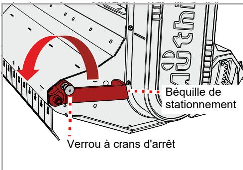
Rabattez la béquille de stationnement vers le bas et fixez-la dans la position inférieure avec le verrou à crans d'arrêt
