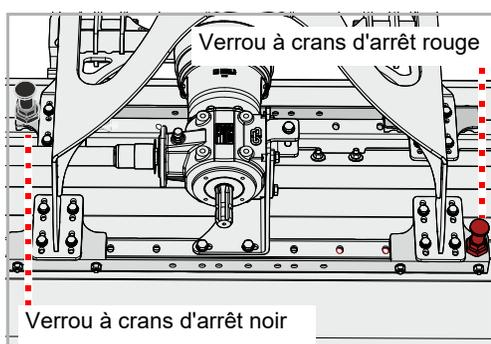
Il y a deux verrous à crans d'arrêt sur la machine :
