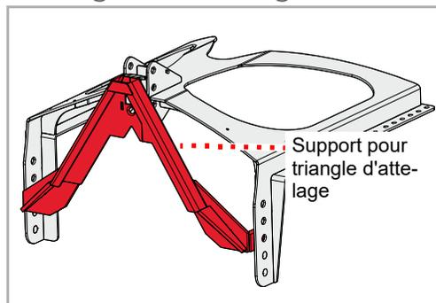
Triangle d'attelage pour montage frontal sur véhicules porteurs, catégorie :
