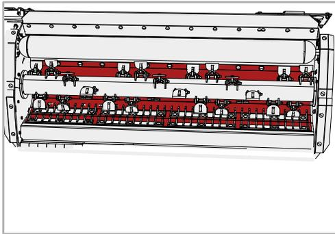
Eine Einlage aus Metall schützt das Gehäuse vor Verschleiß.
