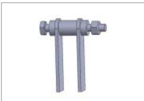
Die rotierenden Vertikutiermesser zerschneiden gezielt die Filzschicht in der Wurzelhalszone der Gräser. Sie erreichen so eine verbesserte Bodenstruktur und gesündere Gräser. Pendelnd aufgehängt weichen die Vertikutiermesser Fremdkörpern aus.
