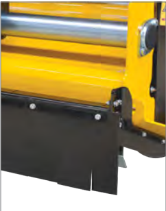
Erweiterte Abhalteeinrichtung bei extrem starkem Steinbesatz (optional).
