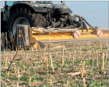
Soloeinsatz des Mulchgerätes durch leichte Demontage der Saateinrichtung möglich.
