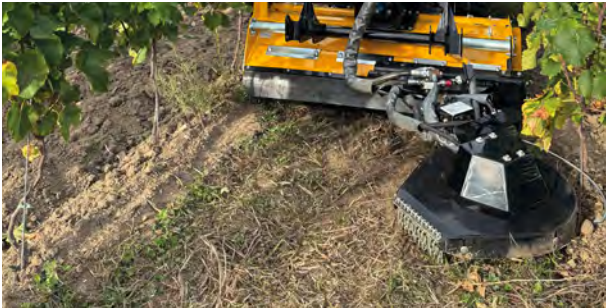
Kettenschutz (nur bei Variante mit hydraulischem Taster) am Gehäuseauslass sowie Schutzabdeckung des Scheibenkörpers zur Schonung des Bestandes
