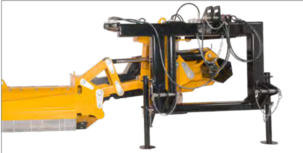
Stabiler Dreipunktbock mit Kat. 2 und 3 Anbaupunkten.
