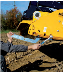
Einfaches Verstellen der Schwenk-Stützwalze, auch ohne zusätzliche Helfer.
