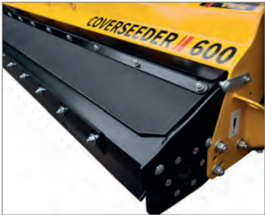
Große Stützwalze mit robuster Starinth Stützwalzenlagerung zur Arbeitshöhenverstellung des Mulchgerätes und zur Erzeugung des Bodenschlusses für das Saatkorn.
