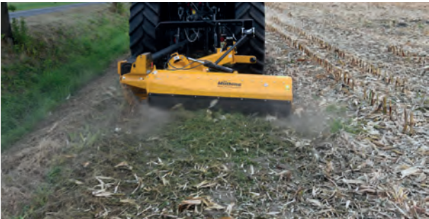
Ein großzügiger Schwenkbereich ermöglicht das Arbeiten sowohl hinter als auch neben dem Traktor. Enge Zufahrten und Feldränder können gleichermaßen gemulcht werden.
