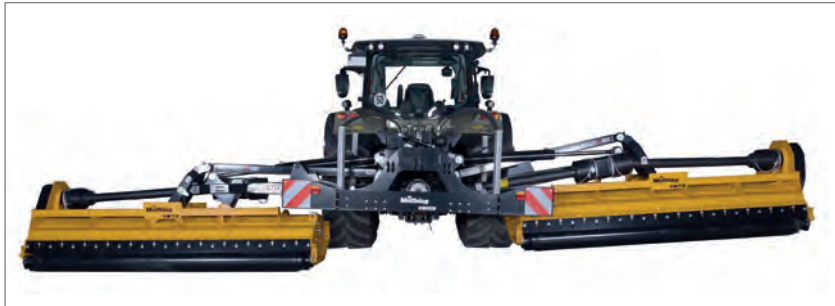
Die Mulchgehäuse lassen sich auch einzeln ausheben.
