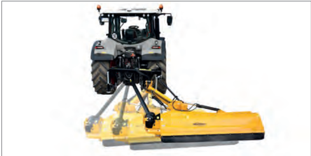
Ein großzügiger Schwenkbereich ermöglicht das Arbeiten sowohl hinter als auch neben dem Traktor. Enge Zufahrten und Feldränder können gleichermaßen gemulcht werden.
