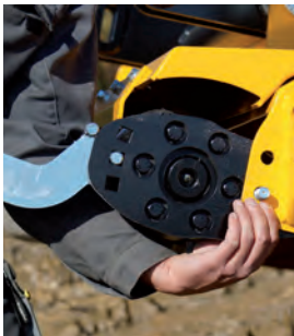
Der Abstreifer hält die Stützwalze sauber und reduziert die Staubentwicklung (optional).
