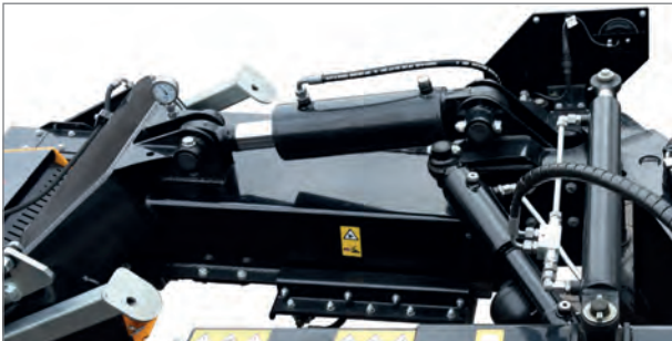
Hydropneumatische Auflagedruckentlastung für optimale Bodenangepassung.
