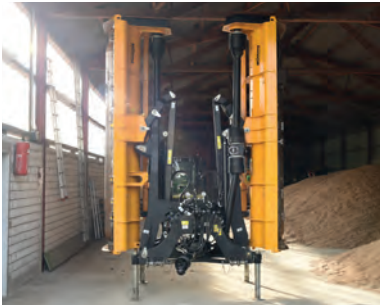
Dank durchdachter Bauweise lässt sich das MU-PRO/F VARIO Mulchgerät platzsparend zusammengeklappt abstellen.
