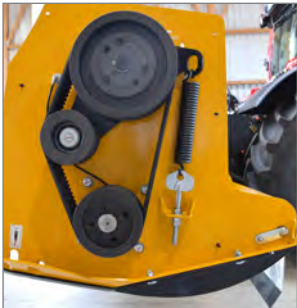
Störungsfreies und wartungsarmes Arbeiten durch die effektiv ausgeführte automatische Riemenspannung.
