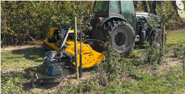
Je nach Art des Einsatzgebietes lässt sich die Sensitivität der Feder-schwenkung/ Tastersteuerung individuell vom Nutzer einstellen.
