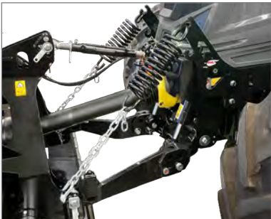
Die Frontfederentlastung sorgt für eine optimierte Bodenanpassung und führt durch eine Belastung der Vorderachse zur besseren Traktion und Lenkeigenschaft des Traktors (optional).
