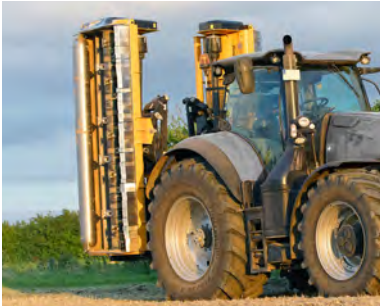
Kurze Bauweise für einen Schwerpunkt nah am Traktor (Quickhitch-geeignet).
