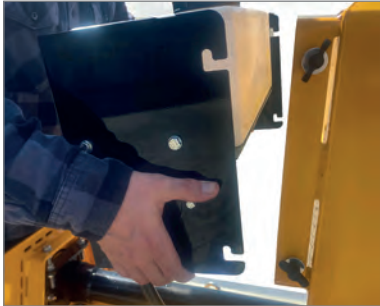
Abnehmbare Pumpeneinheit für Wartungszwecke und zum Schutz vor Frost.
