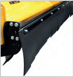
Erweiterte Abhalteeinrichtung bei extrem starkem Steinbesatz (optional).
