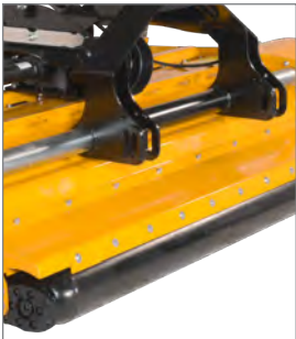
Der Abstreifer hält die Stützwalze sauber und reduziert die Staubentwicklung (optional).
