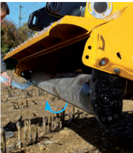
Einfaches Verstellen der Schwenk-Stützwalze, auch ohne zusätzliche Helfer.
