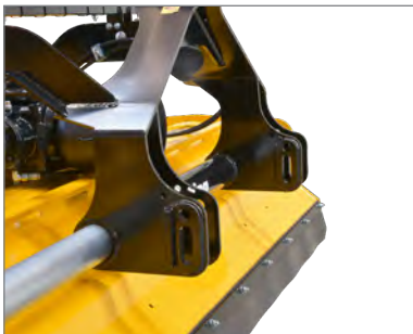
Langlöcher in Kat. 2 an den Ober- und Unterenkeranbaupunkten ermöglichen zusammen mit der Schwenk-Stützwalze eine sehr gute Bodenanpassung.
