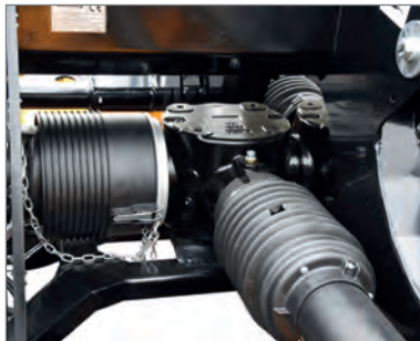
Die durchdachte Bauweise ermöglicht ein leistungsfähiges Doppelgetriebe und eine geteilte Krafteinleitung pro Seite.
