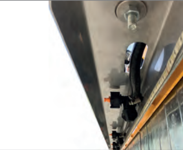
Spritzbalken in der Front und im Heck aus Edelstahl.
