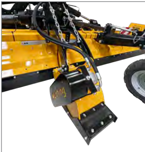
Hydraulisch angetriebenes Streifenmulchgerät - Erforderliche Hydraulikanschlüsse: 1 x Druckleitung mit Stecker BG 2, 1 x druckloser Rücklauf mit Muffe BG 3, (optional)
