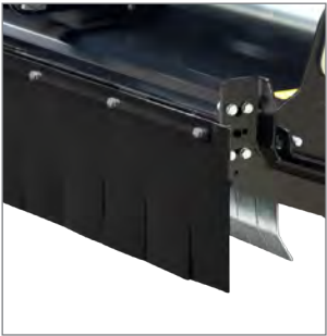
Erweiterte Abhalteeinrichtung bei extrem starkem Steinbesatz (optional).
