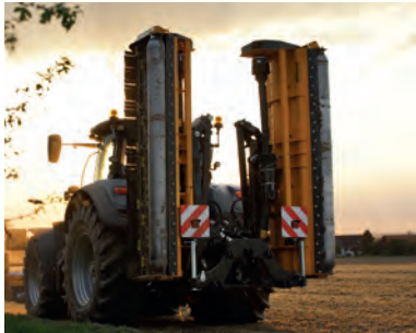
Clever geklappt: Minimale Gerätehöhe durch Parallelogrammaufhängung der beiden Mulchgehäuse.
