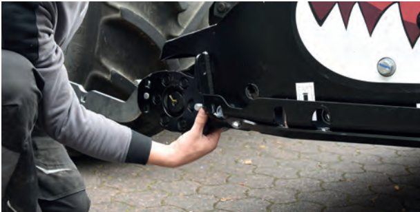
Einfaches Verstellen der schwenkbaren Stützwalze auch ohne zusätzliche Hilfe.
