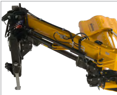
Aufgeräumt: die Schlauchverlegung.
