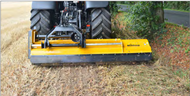
Hydraulische Seitenverschiebung: Versetztes Mulchen neben dem Traktor schafft Flexibilität bei Bäumen, Einfahrten oder anderen Hindernissen (optional).
