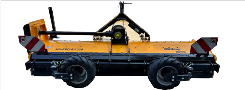
Ackerfahrwerk mit 2 Rädern 26×10.50-12, 180° drehbar (optional)
