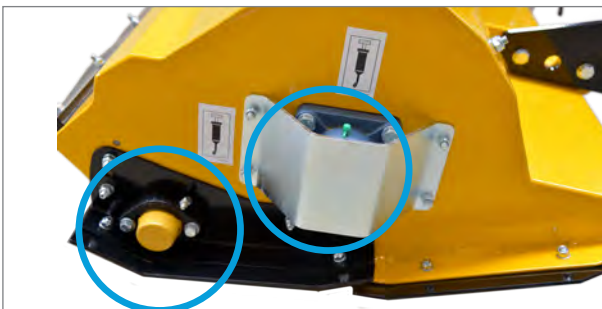
Gut zugängliche Lagerstellen für eine schnelle Wartung.
