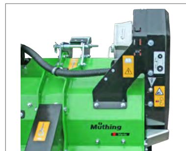
Keilriemenspannung immer im Blick: Keilriemenschutz mit Kontrollöffnung.
