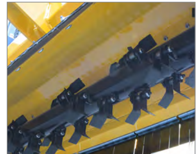
Durch die am Rotor montierten speziellen Y-Messer bei einer variabel verstellbaren Arbeitshöhe bis ca. 11 cm entsteht eine geringere Sogwirkung, wodurch Reptilien und Kleinlebewesen am Boden verbleiben und nicht mit den Y-Messern in Kontakt kommen.
