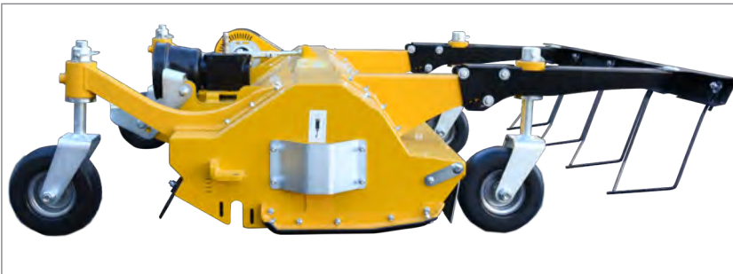
Zur Bewahrung des Bodenlebens werden statt einer Stützwalze bewusst Front- und Heckstützräder verwendet, die keinen breitflächigen Bodenandruck erzeugen.
